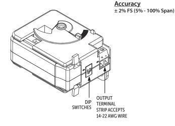
RIBXGT420-RMS DIP SWITCH RANGE OFF OFF 0-10A OFF ON 0-20A ON OFF 0-50A
